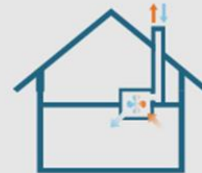
Mechanische toevoer & afvoer
