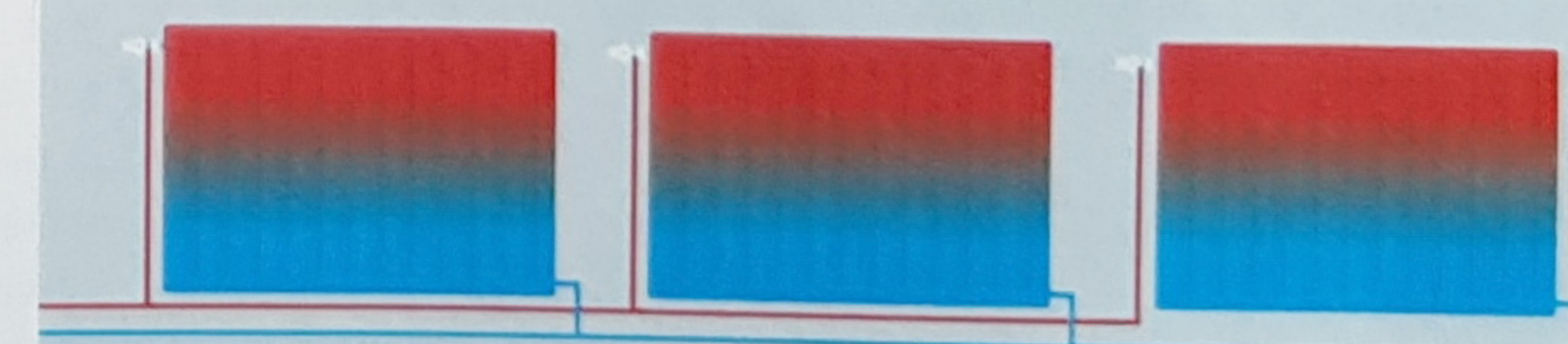
Goed ingeregelde radiatoren
